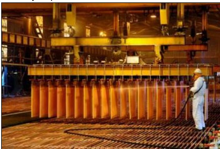
Figura 22. Equipo de Electro-obtención de Cu típico
