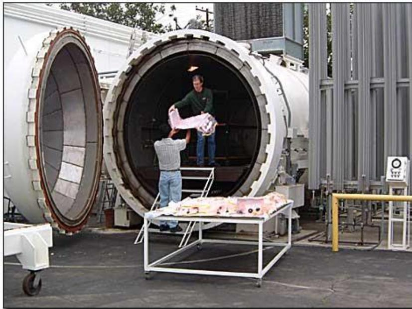
Figura 21. Equipo Autoclave típico
