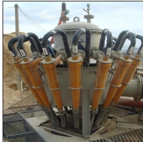
Figura16. Batería de hidrociclones típica
