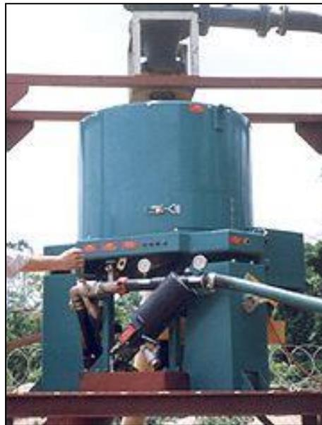
Figura 17. Concentrador Gravimétrico Knelso
