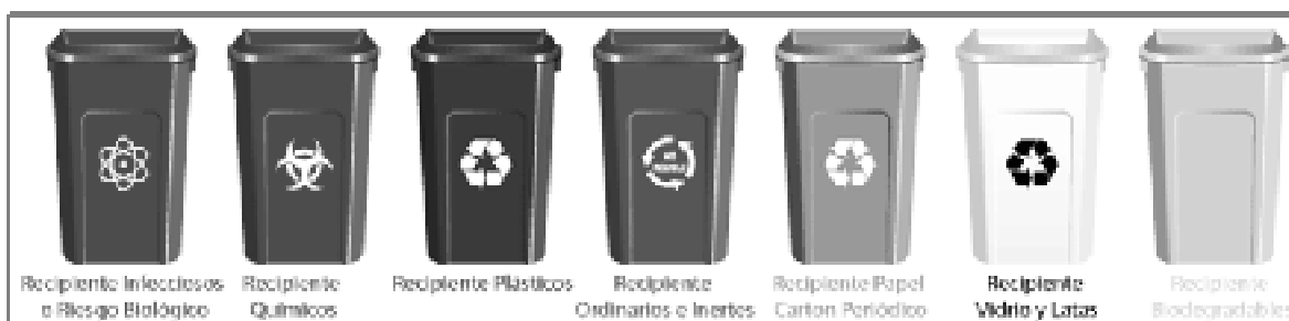
Figura 7.1-14 Identificación de recipientes para almacenamiento de residuos
